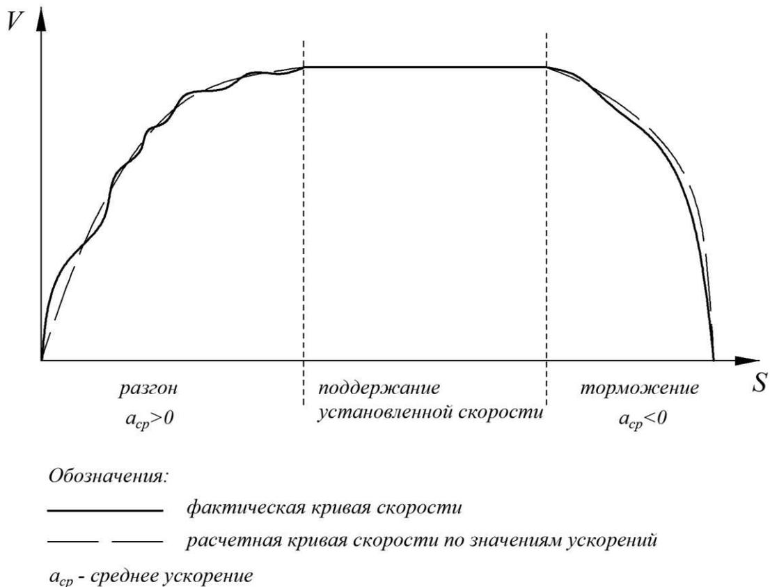
Рисунок 2.1 – Кривая скорости движения поезда
